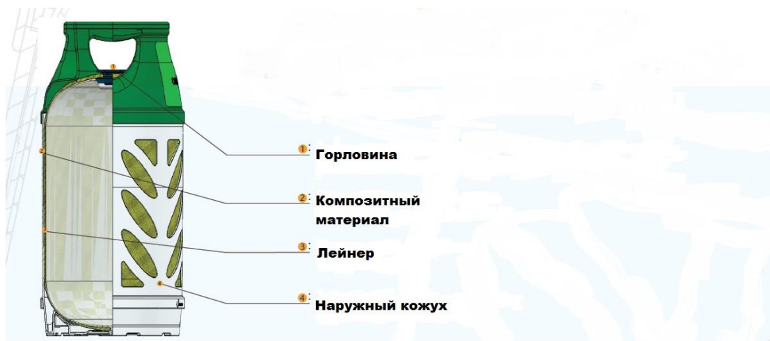
Рис. 1 Эскиз баллона композитного газового низкого давления Ragasco 33.5 л с разрезом.
